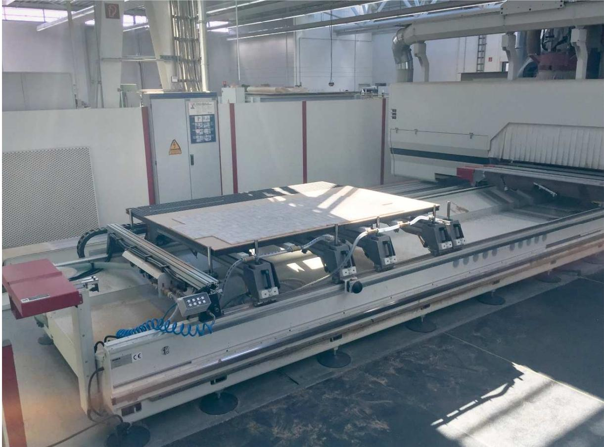
*Abbildung 4: Formholzplatte auf dem Vakuumtisch des Bearbeitungszentrums*
